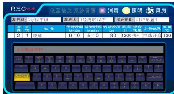
3. 点“程序名”后，弹出软键盘，以拼音方式输入：赛百纯3孔法。按回车确认。
